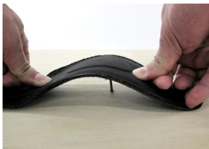
インソールだけでも釘は貫通しません。 約100kgの荷重に耐える踏み抜き性能。
